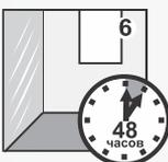
**6** Работы проводить при температуре воздуха и основания от +5 до +30 °С и относительной влажности воздуха не более 75%. Рекомендуемая влажность основания не более 10%.
