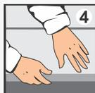
**4** После нанесения клея на основание в течение 10-15 минут положите на клей приклеиваемый материал и прижмите его.
