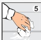
**5** Остатки клея удалите влажной губкой, инструменты промойте водой с моющими средствами. Эксплуатацию склеенных поверхностей можно начинать после полного отверждения.
